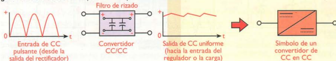
Figura 7.7. Acción básica del filtro en una fuente de alimentación
